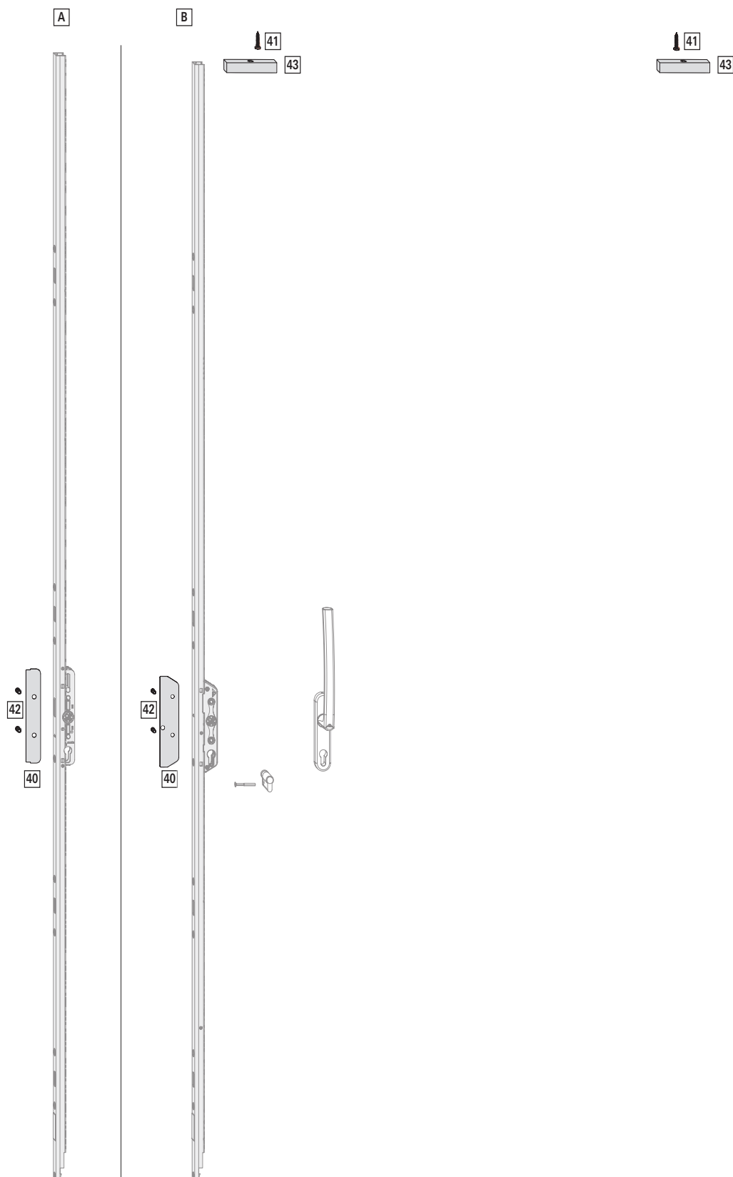
Afb. 4.11: Afgebeeld: schema A; uitvoering links; VH 2400 mm; Slim [A] 200 kg en standaard [B] VG 300 / 400 kg; afsluitbare krukken
