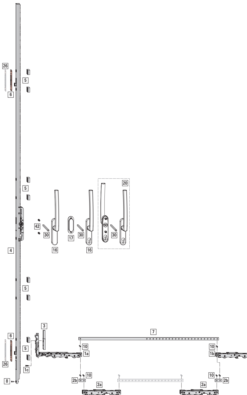
Fig. 4.3: in figura: variante sinistra; LB 1400 mm; AB 2400 mm; PA 200 / 400 kg
