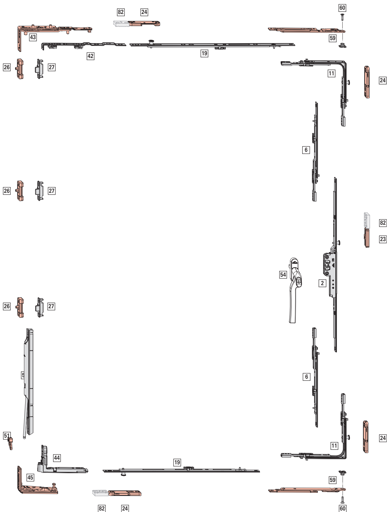
Fig. 4.5: Figura para perfiles de madera, perfiles de PVC bajo petición
